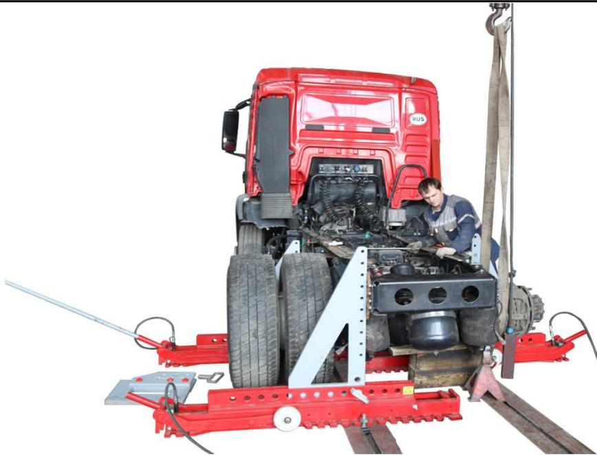
Стенд SIVER TRUCK предназначен для исправления геометрии рам грузового автотранспорта. Основу станда составляет система рельс, заливаемая вровень с бетонным полом. Силовыми элементами являются горизонтальные силовые устройства и вертикальные домкраты. В дополнение к ним могут использоваться горизонтальный упор и анкерные цепи с фиксаторами.
